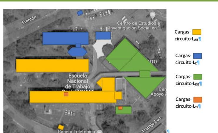
Figura 5. Distribución de las cargas eléctricas en los circuitos medidos por zonas dentro de la ENTS.
